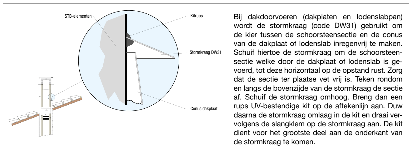
Figuur 12 - Montage stormkraag
